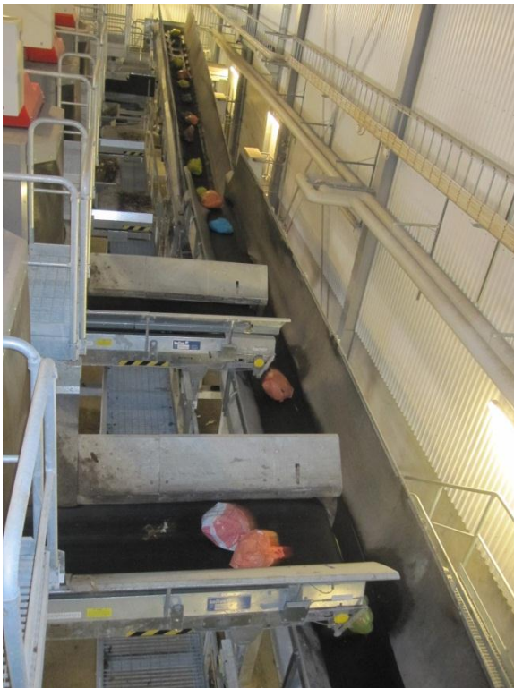
Figur 1 Optisk sortering i Eskilstuna. Här sker sortering i sex olika fraktioner.
